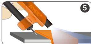
5 付属のUV LEDライトを4秒間〜照射し、BONDIC®を硬化させます。必要な厚さに応じて、何層か作製します。それぞれの層毎に硬化させて下さい。
