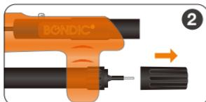
2 リフィルのキャップを外します。先端は細かい部分や隙間にも塗りやすい細いノズルになっています。
